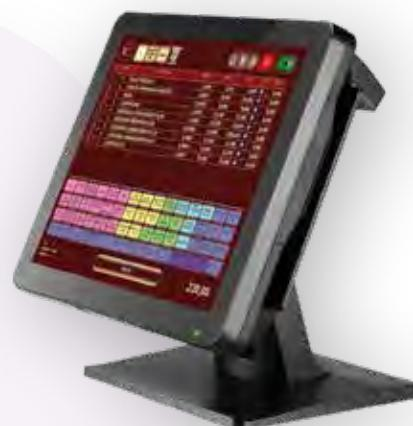
Optimalan POS terminal u pogledu cjenovne prihvatljivosti i kvalitetnih performansi. Fleksibilan modularan dizajn s mogućnošću priključka dodatnog displaya. Prednji panel otporan na prašinu i tekućine (IP65). Uređaj je pogodan za montažu na zid (VESA) - široki ugao nagiba.
